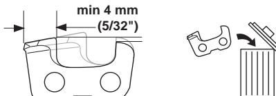
Общие сведения относительно снижения ограничителя глубины врезания.
