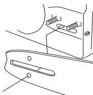
Для этого поверните винт механизма регулировки цепи по часовой стрелке. Цепь следует натягивать до тех пор, пока она не будет плотно прилегать к нижней стороне пильного полотна. См. указания в разделе Натяжение цепи пилы.
