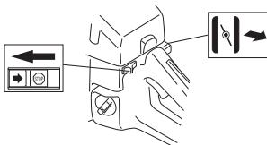
Если машина оборудована декомпрессионным клапаном (A): Его необходимо нажать, чтобы уменьшить давление в цилиндре и облегчить запуск машины. При запуске машины всегда пользуйтесь декомпрессионным клапаном. После запуска машины он автоматически вернется в свое первоначальное положение.
