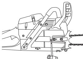
Цепь считается натянутой правильно, если она свободно проворачивается рукой. После этого, удерживая носок пильного полотна в верхнем положении, затяните гайки крепления пильного полотна универсальным ключом.
