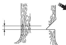
Вставьте зубчатый упор (если установлен), сзади надреза. Работайте на полном газу и вводите пильное полотно в ствол дерева постепенно, плавным движением. Следите за тем, чтобы дерево не начало перемещаться в направлении, противоположном предполагаемому направлению падения. Как
