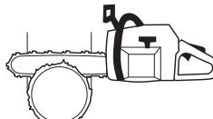
Существуют методы валки деревьев с полотном, меньшим диаметром ствола. Однако эти методы достаточно опасны, т.к. область отдачи полотна входит в контакт с предметом.
