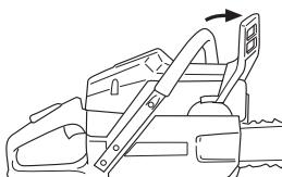
**Зажигание:** Установите переключатель зажигания в левое положение.
