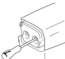
В некоторых глушителях предусмотрен специальный искрогаситель. Если ваша машина оборудована таким глушителем, сетку фильтра следует чистить раз в неделю. Наилучшие результаты достигаются при использовании стальной щеткой. Забитая решетка приводит к работе с горячим двигателем, что дает серьезные повреждения двигателя.
