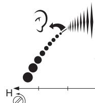
• Машина сейчас проверена в положениях  $H=±0$ ,  $H=+1/4$  и  $H=+1/2$  относительно начального положения. При каждом положении (на полных оборотах) двигатель работал с разным звуком. Жиклер H выставлен верно, если пила слегка "четверит". Если машина "свистит", смесь слишком бедная. Если машина сильно "четверит" с обилием выхлопных газов, смесь слишком богатая. Поворотом жиклер H по часовой стрелке добейтесь правильного звука двигателя.
