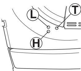
Необходимое качество воздушнотопливной смеси, зависящее от потока воздуха, регулируемого дроссельной заслонкой, настраивается поворотом винтов регулировки подачи топлива Л и Х. Если их поворачивать по часовой стрелке, то качество рабочей смеси (соотношение воздух/топливо) обедняется (меньше топлива), а если их поворачивать против часовой стрелки, то качество рабочей смеси обогащается (больше топлива). Обеднение рабочей смеси дает повышение оборотов двигателя, а обогащение - уменьшение.
