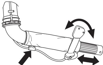
Подсоедините среднюю трубу в соответствующую трубу выдувания. Соедините
