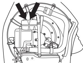
Вытяните сетку искроулавливателя и очистите её стальной щеткой. Замените сетку искроулавливателя, если она повреждена.
