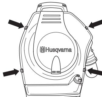
Снимите два фиксатора, удерживающих крышку воздушного фильтра и снимите фильтр. Промойте фильтр начисто в теплом мыльном растворе.
